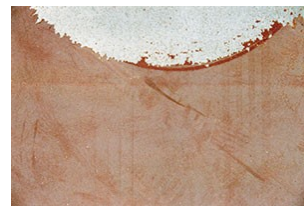
Bild 13:16. Vid vattenblästring kan nedbruten plastisol tas bort. Foto: Fr Ramström AB
